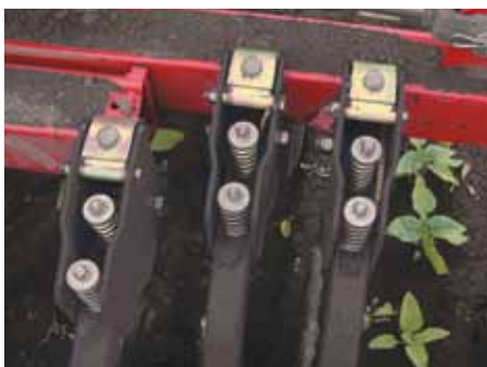
Двухступенчатая регулировка давления на почву
