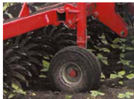
Дополнительный контроль заглубляемости
