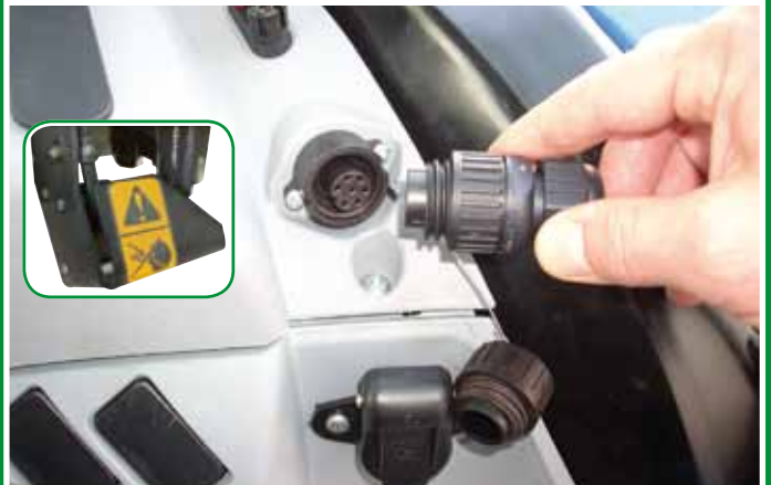
Connessione diretta al radar tramite cavo 7 poli Direct connection to the radar using a 7 pole cable Прямое подключение к радару с использованием 7-полюсного кабеля.
