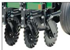
Преднагрузка на режущий диск 204 кг
