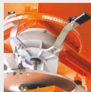
Градированные указатели с отсылкой к таблицам разброса внесения удобрений с максимальной точностью.
