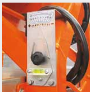
Регулятор наклона для позднего внесения удобрений.
