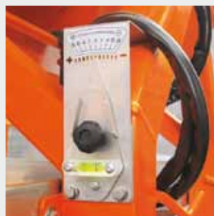
Регулятор наклона для позднего разброса.
