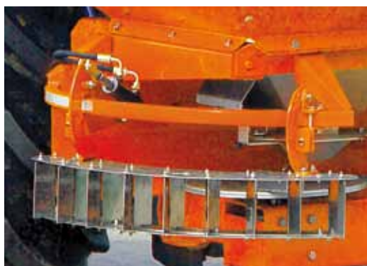
Подвижный ограничитель, приводимый в действие гидравлическим приводом для ограниченного разброса.
