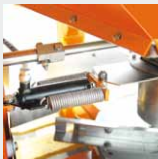
Гидравлический привод для открытия и закрытия выходов.
