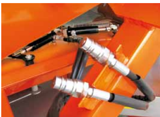
Гидравлический привод дозаторов. Открытие и закрытие выполняется при помощи гидравлики из кабины трактора. Возможно управление обоими выходами или только одним выходом – справа или слева.
