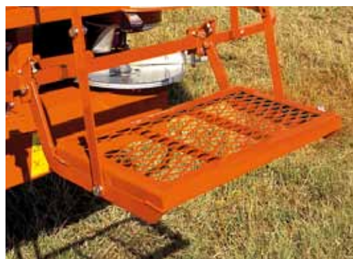
Закрывающаяся загрузочная площадка.
