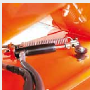
Гидравлический привод для открытия и закрытия выхода удобрений.
